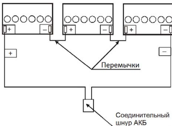
Рисунок 1. Схема соединения аккумуляторов в батарею.
