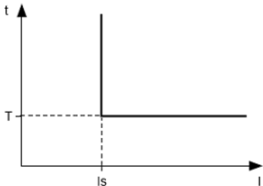
Рисунок 1.2 - Принцип защиты с независимой выдержкой времени
