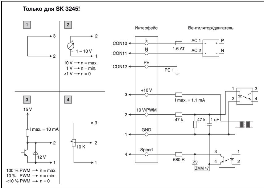
Рис. 12: Схема подключения 3245
