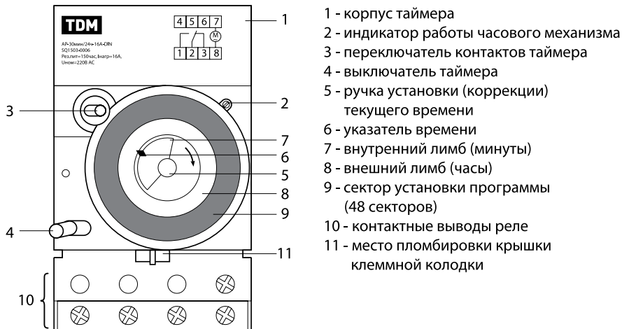
Рисунок 4. Элементы управления реле AP
